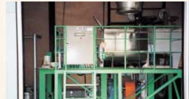
茨城県竜ヶ崎町【飼料化】 【プライムデリカ(株)竜ヶ崎工場:自社処理】 生ごみは加熱脱水処理後、発酵乾燥処理で飼料化。製造された飼料は埼玉県三郷市にある養鶏の餌として使用されています。
