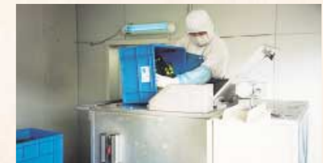
千葉県八街市【堆肥化】 【(株)ツルコ・コーポレーション 千葉工場 他所沢工場・湘南ファクトリー:自社処理】 生ごみは杉チップと微生物を混合攪拌し減量後、鶏糞・パグとともに2年半かけ完熟有機質堆肥化。できた堆肥は契約農家にて使用されています。
