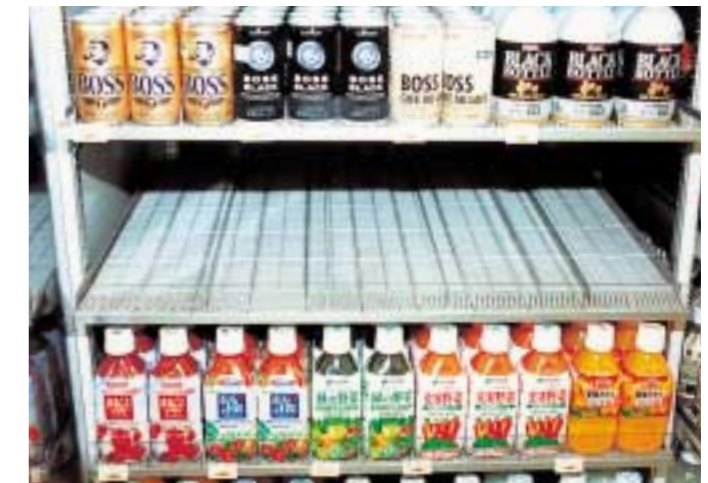
ローラー式敷板の使用状況
