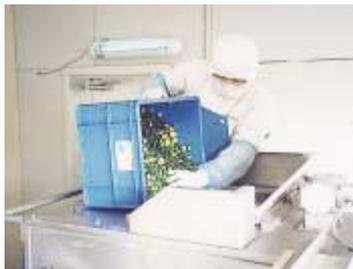
◀工場で、野菜残渣を一時処理として杉チップなどと混合攪拌します
