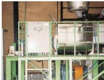
◀生ごみを加熱脱水処理した後、発酵乾燥処理を行います
