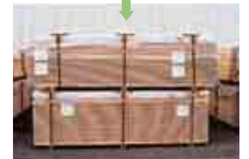
簡易梱包の断熱パネル 梱包材使用量：合計約115㎡ (標準店舗1店舗あたり) 断熱パネルがセブン・イレブン仕様で、工場から店舗までの配送ルートが明確、管理が可能ことから実現
