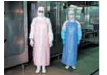
工場では床やエプロンの色を変えることで、衛生レベルの区分けを明確にし、レベルの異なる従業員の交差を防いでいます。2004年2月末時点で、18工場がNDF HACCP認定を取得。現在、全工場が取得を目指して取り組んでいます
